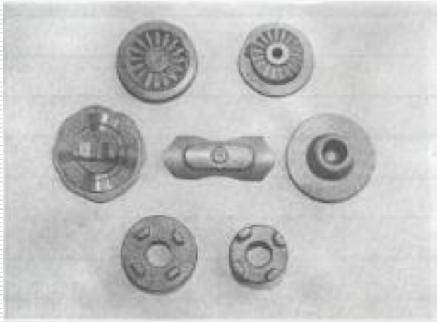
擺輓鍛造製程所鍛製 (棘輪、排檔齒輪、端面凸輪等)
