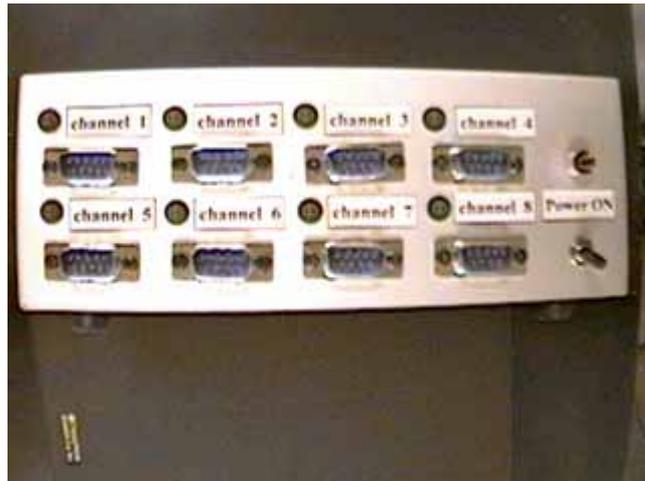
圖 3-16 RS-232 切換器的面板照。
