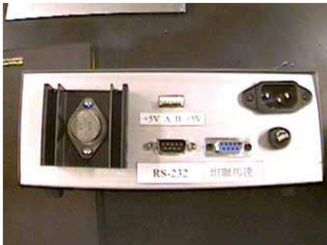
圖 3-24 步進馬達驅動器的後板照。
