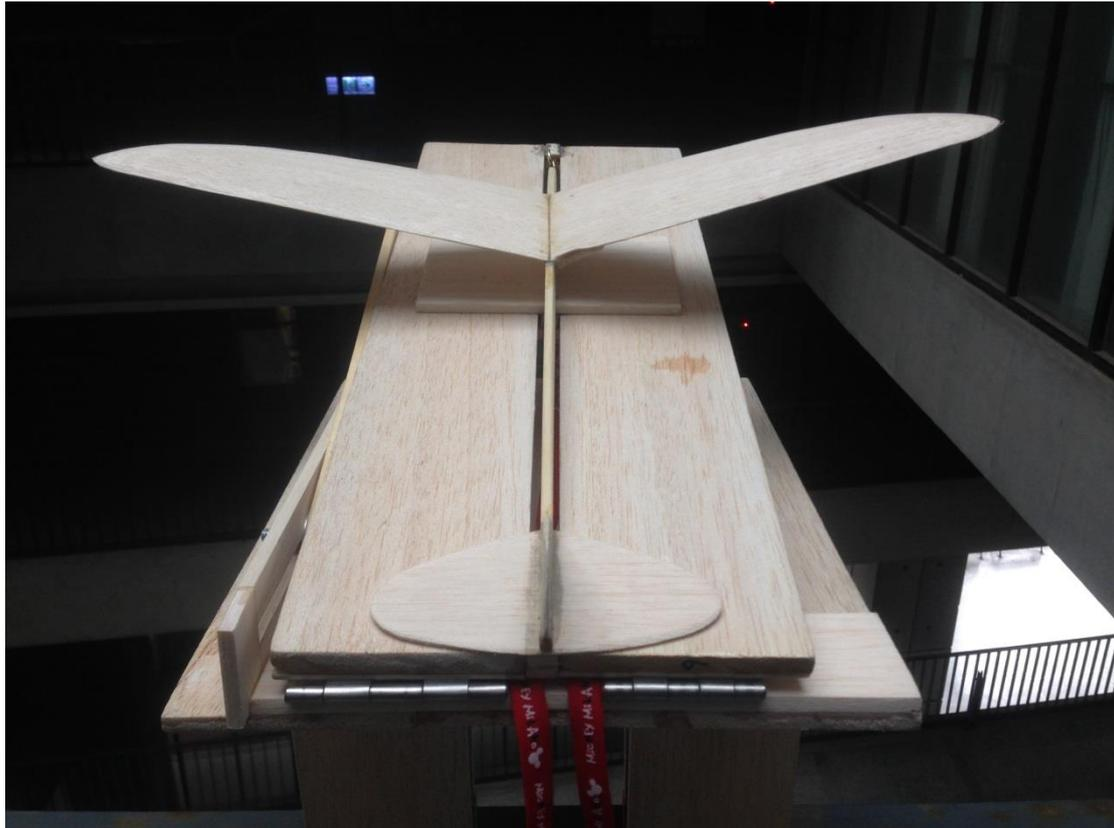
發射器的部分我們使用製作飛機剩餘之巴爾沙木作為基本架構，而發射之動力為彈簧，另外製作一小型發射平台增加飛機在發射時之穩定度，並且在發射平台下增加基座，使得發射台可做發射角度之調整，最後考慮到會在七館欄杆上架設發射器，所以在基座部分增加兩片木板可剛好符合七館欄杆之寬度，避免手拿發射器而造成之不確定因素發生。
