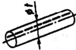
與公差框格連接之圓柱軸線應位於一個直徑為 0.08，且與基準軸線 A-B 同軸線的圓柱區域內。
